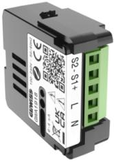
Appareil connecté sans fil selon le protocole Zigbee du système ChoruSmart, utilisable avec Home Gateway pour les solutions « CONNECTED SMART HOME », pour les logements résidentiels et les petits bureaux, à la fois pour les nouvelles constructions et les rénovations. La technologie Zigbee est une technologie sécurisée et fiable, où les données sont cryptées et chaque nœud du réseau garantit l'accessibilité sur tous les appareils (réseau maillé).
