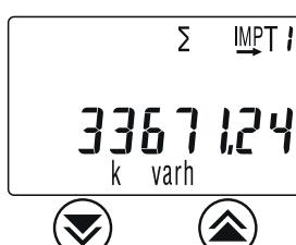
Registro energia reattiva importata tariffa T1 - Reactive imported energy register, fee T1 - Registre de l'énergie réactive importée tarif T1 - Registro de energía reactiva importada tarifa T1 - Zähler eingespeiste Blindenergie Tarif T1
