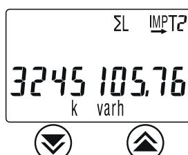
Registro energia reattiva importata tariffa T2 - Reactive imported energy register, fee T2 - Registre de l'énergie réactive importée tarif T2 - Registro de energía reactiva importada tarifa T2 - Zähler eingespeiste Blindenergie Tarif T2
