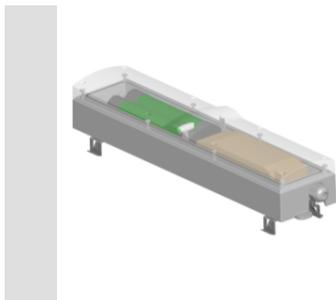
Kit d'urgence dédié en PC gris (RAL 7035) pour Smart [3] câblage traversant. Equipé de batteries Ni-Mh pour une autonomie de 3h. Peut être monté sur l'appareil même à l'aide de ressorts de fixation ou monté au mur / au plafond, à l'aide de vis 4mm.
