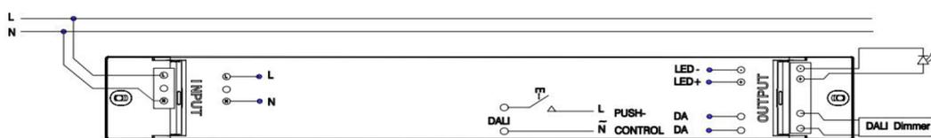
(Une sortie, 2 borniers, la puissance de sortie totale ne doit pas dépasser la puissance de sortie nominale)
