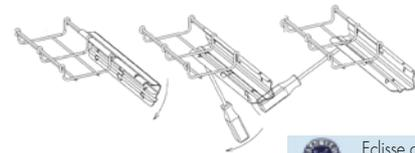
Eclipse conforme NF EN - 61537 continuité électrique
