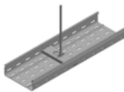
Insertion de la tige avec écrous et embase
