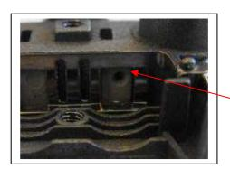
Contact tulipe pour âme de câble coaxial 1.02 à 1.13mm Insertion automatique
