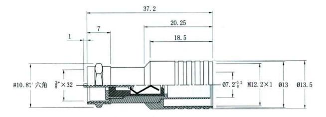
Laiton / recouvrement nickel
