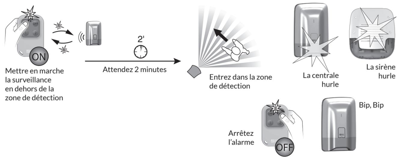
A chaque mise en marche ou arrêt du système, la centrale émet une série de bips, indiquant qu'un événement (ici la détection de mouvement) s'est produit. Vous pouvez le consulter sur un clavier tactile ou sur l'application TYDOM.
