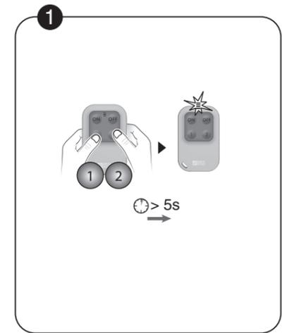
1 Appuyez simultanément 5 secondes sur les touches 1 et 2, jusqu'à ce que le voyant s'allume orange.
