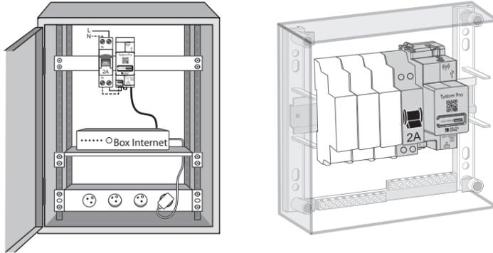
Tydom Pro doit être installé sur rail DIN, soit dans une armoire électrique, soit dans une armoire VDI. L'installation de l'équipement doit être fait par une personne qualifiée uniquement.
