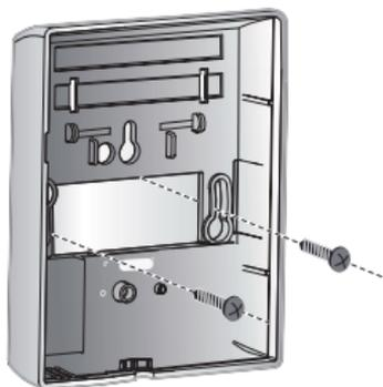
Fixez le socle à l'aide de vis et chevilles adaptées au support ou sur une boîte d'encastrement et refermez le boîtier en le verrouillant.
