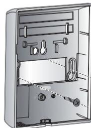
Fixez le socle à l'aide de vis et chevilles adaptées au support ou sur une boîte d'encastement et refermez le boîtier en le verrouillant.
