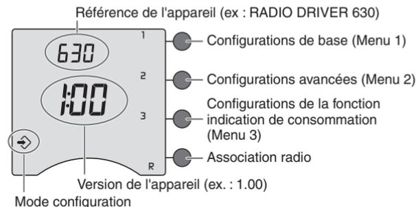
Le menu 3 n'est accessible que lorsque RADIO DRIVER est associé à un RADIO TYWATT ou à la fonction indication de consommation d'un GP8 RADIO CPL (voir menu R).
