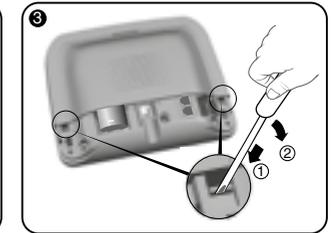
A l'aide d'un tournevis, soulevez les 2 clips maintenant le capot supérieur.
