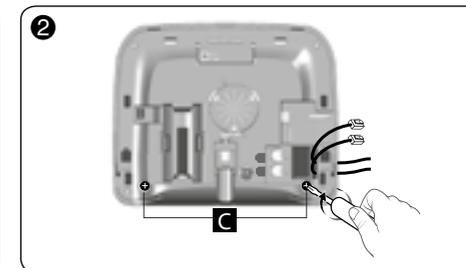
Fixez le boîtier à l'aide de 2 vis Ø 4 mm Max. en utilisant les trous C.
