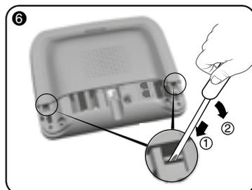
A l'aide d'un tournevis, soulevez les 2 clips du capot supérieur.
