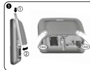
Remplacez le capot supérieur et clipsez-le sur le boîtier.
