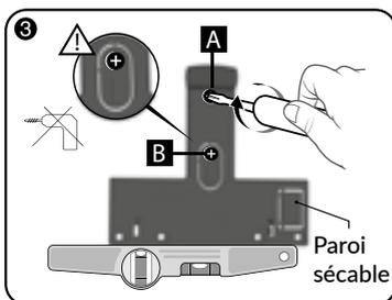
Fixez le support mural à l'aide de 2 vis Ø 4 mm Max. en utilisant les trous A et B. N'utilisez pas de visseuse pour visser la vis repérée B.
