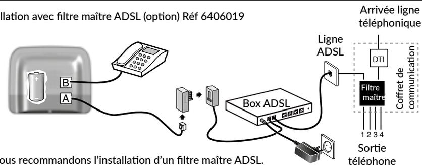
Nous vous recommandons l'installation d'un filtre maître ADSL. Placé en tête de ligne après le Dispositif de Terminaison Interieur, cet appareil atténue fortement les perturbations électromagnétiques en séparant le signal ADSL de la ligne téléphonique. Il améliore la cohabitation des différents appareils connectés sur votre installation téléphonique.
