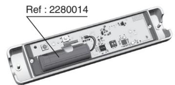
FR L'appareil émet une série de bips à chaque détection, la pile est usée. Le DMDR TYXAL+ utilise un bloc-pile spécifique DELTA DORE. Contactez votre installateur. Si une centrale d'alarme est associée, passez-la en mode maintenance avant d'ouvrir le produit (voir notice d'installation système).
