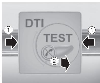
Pour ouvrir le DTI, appuyer sur le haut et le bas du capot et le retirer.
