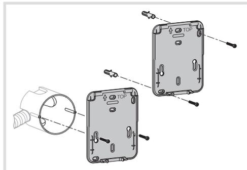
Pour une qualité de régulation optimale, calfeutrez la boîte d'encastrement ou la gaine électrique.
