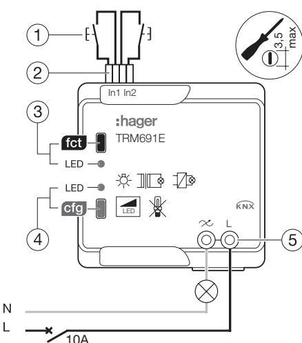
**LED fct** (rode LED = actieve uitgang). De specifieke functies van het product hangen af van de configuratie en de parameterinstelling.
