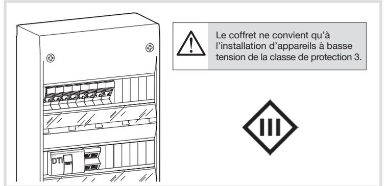
Le coffret ne convient qu'à l'installation d'appareils à basse tension de la classe de protection 3.
