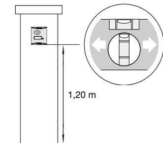
2. Repérer et percer les trous de fixation de la platine de rue avec un forêt de  $\varnothing$  6 mm. Repérer également l'emplacement du trou de passage du câble à percer ( $\varnothing$  8 mm min. recommandé).
