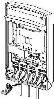
4. Bloquer les câbles raccordés à l'aide du serre-câbles et des vis fournies.
