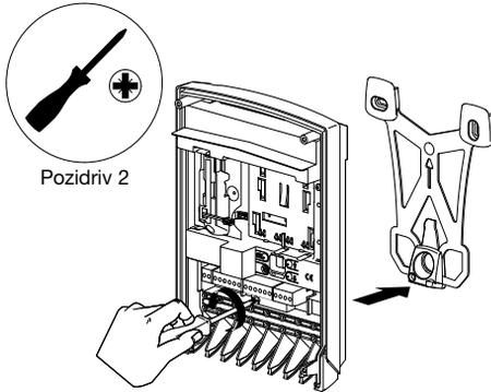
2. En respectant les règles de pose ci-dessous, repérer les 3 points de fixation et percer le pilier avec un foret de Ø 6 mm.
