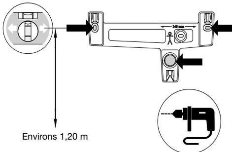
2. Insérer la rondelle et fixer le T à l'aide de vis et de chevilles appropriées.
