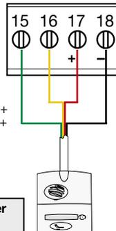
**ASTUCE :** s'il est nécessaire de rallonger le câble entre la platine de rue et le coffret, conserver ou réduire la longueur du câble fournis puis effectuer les raccordements dans une boîte de dérivation en respectant les règles suivantes :
