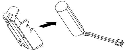
5. La remplacer par une neuve (réf. 908-21X) en prenant bien soin de passer le connecteur dans le trou du boîtier.
