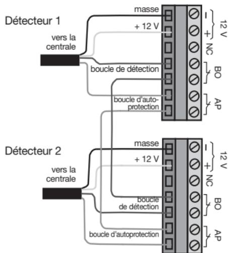
La borne NC peut être utilisée pour ajouter une résistance de bout de ligne sur le détecteur le plus éloigné (valeur 15 k $\Omega$ , livrée avec la centrale Hager). Celle-ci permet la détection d'un court-circuit sur la boucle de détection.
