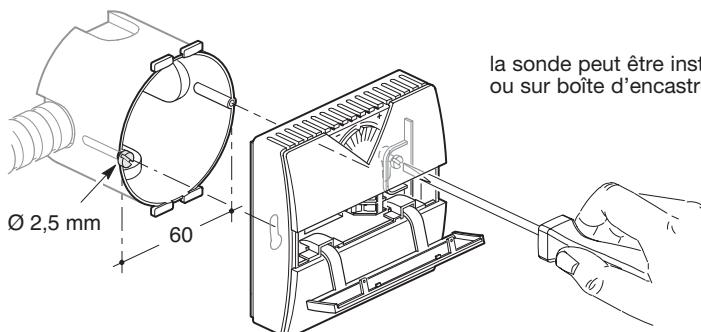
Installer la sonde à 1,50 m du sol, sur le mur intérieur ④ en évitant les influences externes : (① aérateur, ② mur extérieur, ③ rayons de soleil) et internes : (⑤ appareil d'éclairage, ⑥ derrière conduit de fumée, four ⑦ convecteurs)
