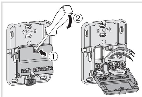
4. Raccordez le produit suivant les schémas électriques ci-contre.
