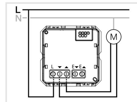
Image 3: Schéma de branchement interrupteur de store
