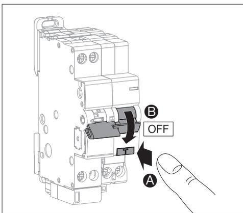
Fig 5 : Tester l'appareil
