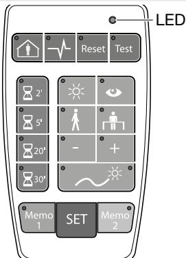
**(FR)** La télécommande permet d'effectuer ou de modifier des réglages sur les détecteurs (voir ci-dessus). Quand le potentiomètre du détecteur est sur "auto test". Les réglages peuvent être simples ou multiples. Les réglages multiples peuvent être enregistrés dans Memo 1 et Memo 2 et rappelés pour configurer plusieurs détecteurs. La touche SET est utilisée pour envoyer les messages IR au détecteur.
