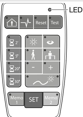
**(DE)** Die Fernbedienung ermöglicht das Einstellen bzw. Verändern der Einstellungen an den Präsenzmeldern (siehe oben), wenn das Potentiometer des Anwesenheitsmeters auf "Autotest" steht. Es können Einfach- oder Mehrfacheinstellungen vorgenommen werden.
