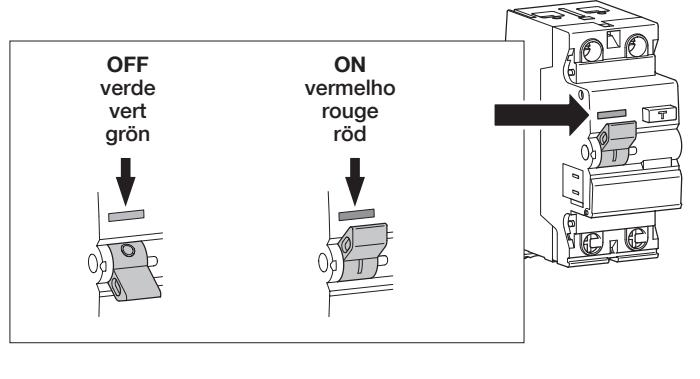
TEST: teste frequente, o interruptor diferencial deve abrir.
