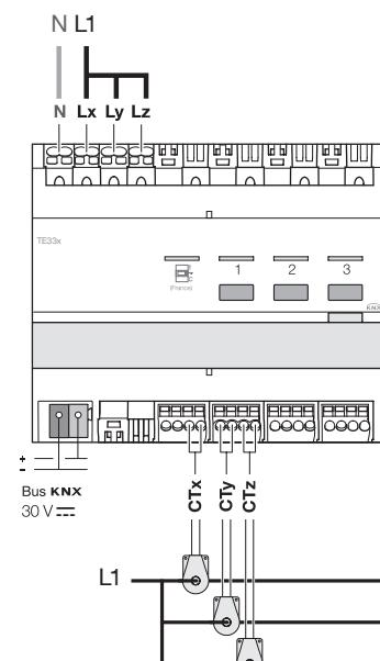
**(FR) Raccordement des tores d'intensité en triphasé**
