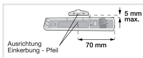
Richten Sie die vertikale Einkerbung des Magnethalters auf den Pfeil am Sockel des Melders aus.
