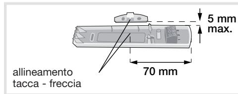
**C** L'allineamento laterale e l'adattamento in altezza sono tassativi per un corretto funzionamento del rilevatore.
