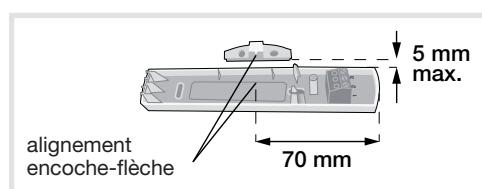
**! L'alignement latéral et l'ajustement en hauteur sont impératifs pour un fonctionnement correct du détecteur.**
