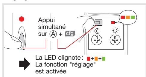
Les seuils de luminosité sont réglés à l'aide des 2 potentiomètres. La couleur de la LED cfg (voir illustration D) indique le résultat de la comparaison entre la luminosité mesurée par le capteur et le seuil réglé sur le potentiomètre.
