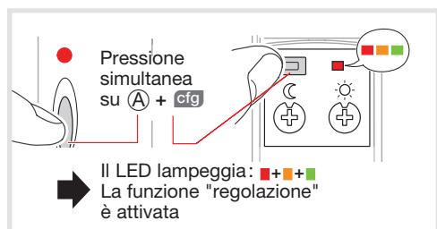
Le soglie di luminosità vengono regolate con l'aiuto di due potenziometri. Il colore del LED cfg (vedere figura D) indica il risultato del confronto tra la luminosità rilevata dal sensore e la soglia impostata sul potenziometro.
