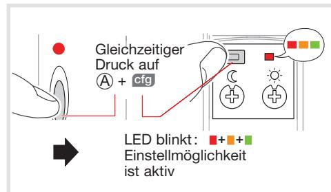
Die Helligkeits-Schwellwerte werden an den 2 Potentiometern eingestellt. Die Farbe der LED cfg (siehe Abb D) zeigt das Ergebnis des Vergleichs zwischen der vom Sensor gemessenen Helligkeit und dem am Potentiometer eingestellten Schwellenwert an.
