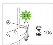
Il prodotto funziona con una periodicità di rilevamento ridotta a 10 sec, anziché di circa 15 minuti (vedere figura D).
