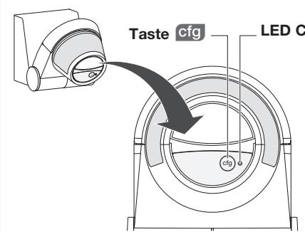
Nach dem Rücksetzen auf Werkseinstellungen ist eine Wartezeit von 15 Sekunden abzuwarten, bevor die Konfiguration vorgenommen werden kann.
