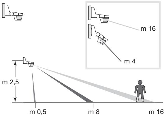
La hauteur d'installation optimale est de 2,5m.
