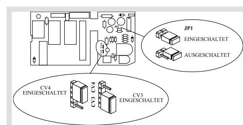
Betrieb des Lüfters (1) in vorgegebener Geschwindigkeit in Abhängigkeit von der Temperatur. Die Brücke JP1 muß ausgeschaltet bleiben (die Brücke CV3-CV4 muß sich in der auf der Zeichnung "CV4 EINGESCHALTET" angegebenen Position befinden).
