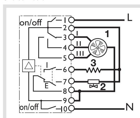
Fonctionnement du ventilateur (1) sur la vitesse sélectionnée en fonction de la température. Le cavalier JP1 reste déconnecté. Le cavalier CV3 doit être dans la position CV4 connecté.
