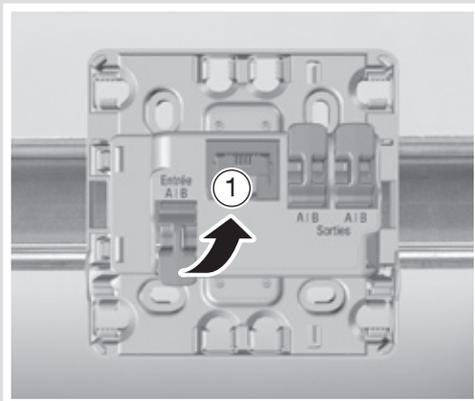
1. Basculer le couvercle du module de connexion.
