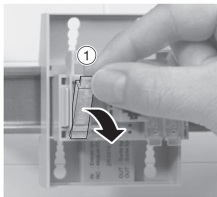
1. Basculer le couvercle du module de connexion
