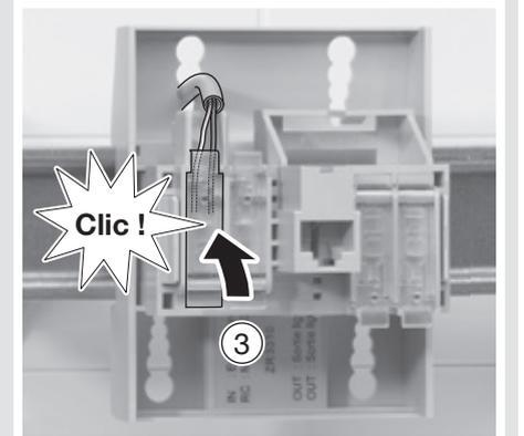
3. Rabattre complètement le couvercle du connecteur et ajuster le câble dans le boîtier
