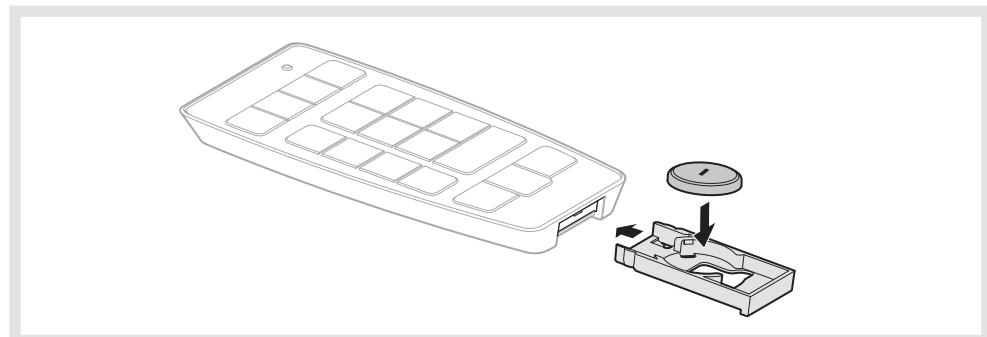
La télécommande permet d'effectuer ou de modifier des réglages sur les détecteurs EE815, EE816 et TCC52.E. quand le potentiomètre du détecteur est sur "auto test". Les réglages peuvent être simples ou multiples. Les réglages multiples peuvent être enregistrés dans Memo 1 et Memo 2 et rappelés pour configurer plusieurs détecteurs. La touche SET est utilisée pour envoyer les messages IR au détecteur.
