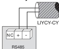
Ajouter si nécessaire la résistance de terminaison de 120 Ohm entre les bornes "+" et "-". / If necessary add the 120 Ohm module between the "+" and "-". / Bei Bedarf verwenden Sie ein 120 Ohm Widerstand zwischen "+" und "-".
