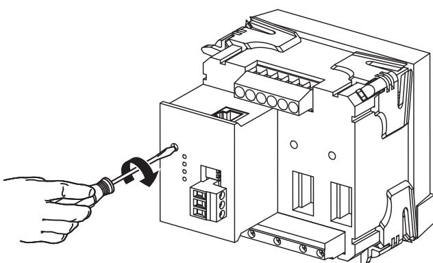
④ Raccorder le bornier en respectant les indications.
