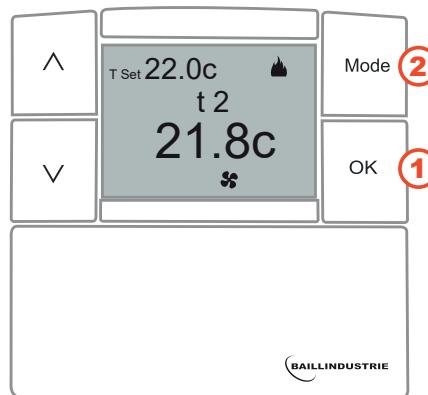
Effectuez **2** appuis rapides sur la touche **MODE**, puis, dans les 5 secondes maximum, appuyez **1** fois sur la touche **OK** pour valider le passage en **mode OFF** du thermostat. Pour rapplumer le thermostat, il vous suffit d'effectuer un seul appui sur la touche **MODE**.
