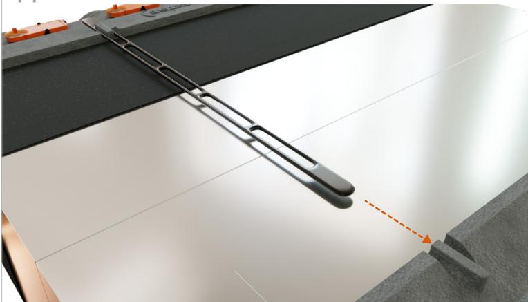
Utilisez les ergots afin de **bien tendre** les élastomères de fixation et ainsi lier le plénum de soufflage et de reprise. *Pensez également à en placer par le dessous !*
