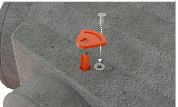
Dans le cas d'un volet manuel vissez d'abord une cheville en nylon puis insérez le palier de guidage manuel et enfin la vis de serrage.
