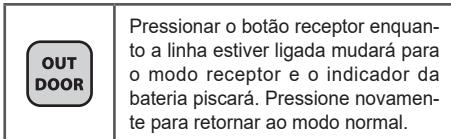
Pressionar o botão receptor enquanto a linha estiver ligada mudará para o modo receptor e o indicador da bateria piscará. Pressione novamente para retornar ao modo normal.
