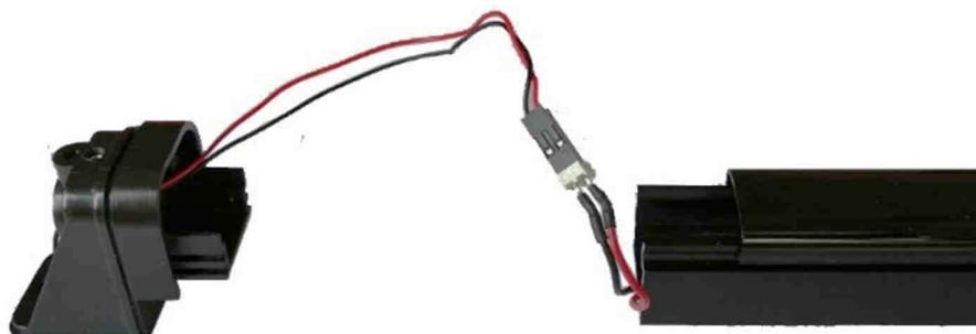
*NOTE ! Veiller à respecter le sens d'introduction du connecteur du tamper sur le connecteur de la barrière : les deux connecteurs doivent être parfaitement unis comme indiqué sur la photo précédente.*
