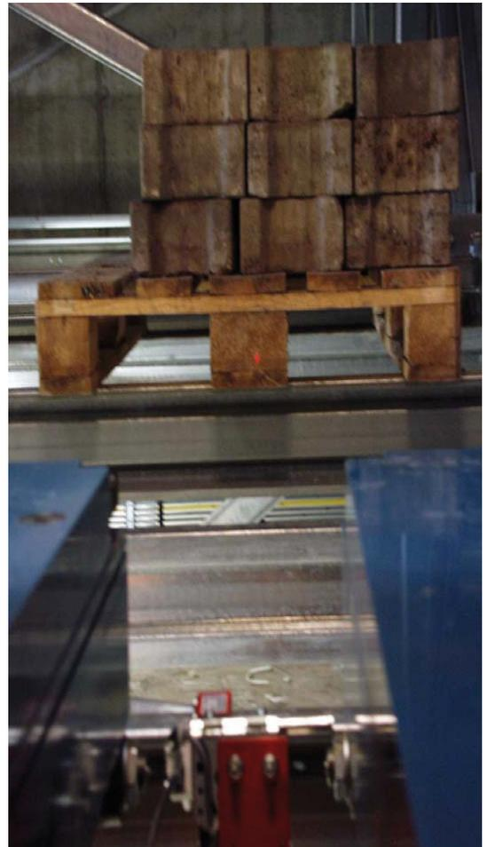
Contrôle du défilement avec HRTL 96B M/6.4.02S-S12 (50111815) à l'aide d'un apprentissage externe
