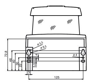
Espace minimal nécessaire pour le montage et le remplacement du scanner
