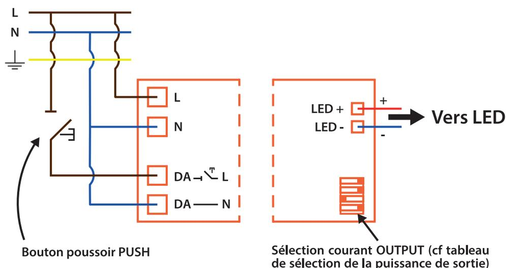
*Câblage PUSH = maximum 10 alimentations par circuit de commande*
