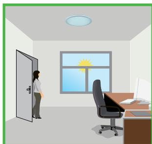
Avec un éclairage naturel suffisant, la lumière ne s'allume pas lorsqu'une présence est détectée.
