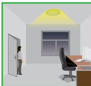
En cas de lumière naturelle insuffisante, le capteur allume automatiquement la lumière lorsqu'une présence est détectée.
