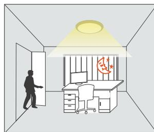
Avec un mouvement et un niveau de lux ambiant insuffisant, la lumière est déclenchée à 100% par le détecteur.
