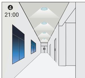
La lumière se rallume automatiquement à un niveau faible lorsqu'aucun mouvement n'est détecté.
