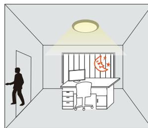
S'il n'y a plus de mouvement, la lumière passe au niveau de veille après le temps de maintien.
