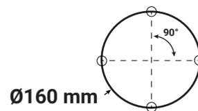
Schéma de pré-perçage de fixation
