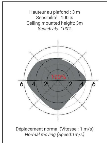
Lorsqu'il y a plusieurs applications de capteur sur le même site, il est recommandé que l'espacement d'installation du produit soit supérieur à 2 m. Trop dense peut provoquer un faux déclenchement. Pour éviter les interférences radio, le capteur doit être éloigné de l'échangeur, du routeur et de tout autre appareil sans fil (distance supérieure à 2,5 m).
