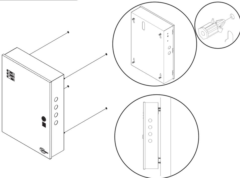
Pour déporter le coffret d'alimentation du mur utiliser les entretoises fournies. Dans ce cas nous préconisons des vis de 50 mm.
