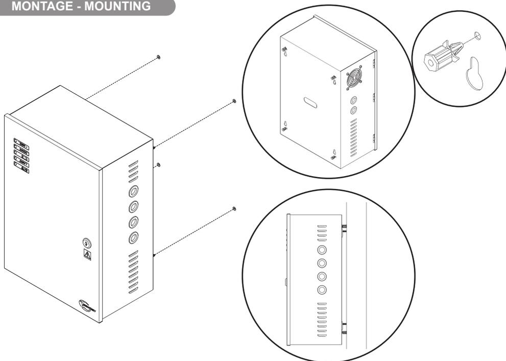
Pour déporter le coffret d'alimentation du mur utiliser les entretoises fournies. Dans ce cas nous préconisons des vis de 50 mm.
