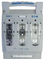
Interrupteur-sectionneur, 400 A, AC 690 V, NH2, IEC, type de platine de montage, avec microrupteur
